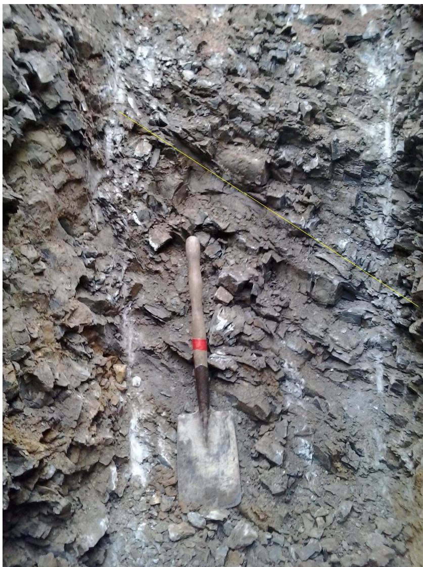
Fot. 2b. Pkt. 3 (wykop badawczy). Wykop wykonany. Widoczny upad warstw, ca 45 stopni
