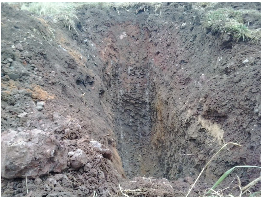
Fot. 2a. Pkt. 3 (wykop badawczy). W dolnej części wykopu widoczny upad warstw, ca 45 stopni (vide fot. 2b).
