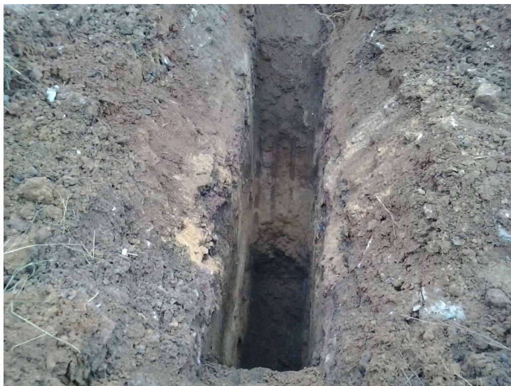
Fot. 1a. Pkt. 2 (wykop badawczy). Wykop wykonany. Widoczna warstwa piasku w interwale głębokości 1,5 do 2,7 m ppt.
