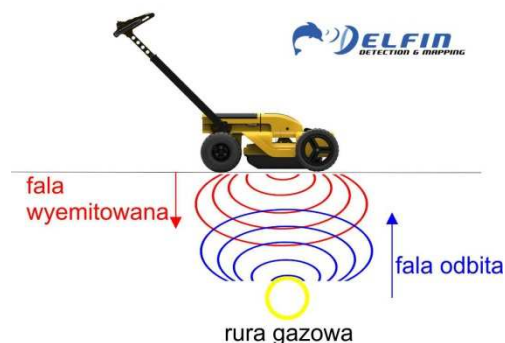
Rysunek 2 Przykład wykrywania rur niemetalicznych
